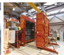
壁や屋根の水密・耐風・気密度を測定する装置
