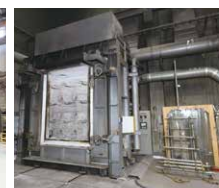
壁の防火試験を行う防耐火炉
